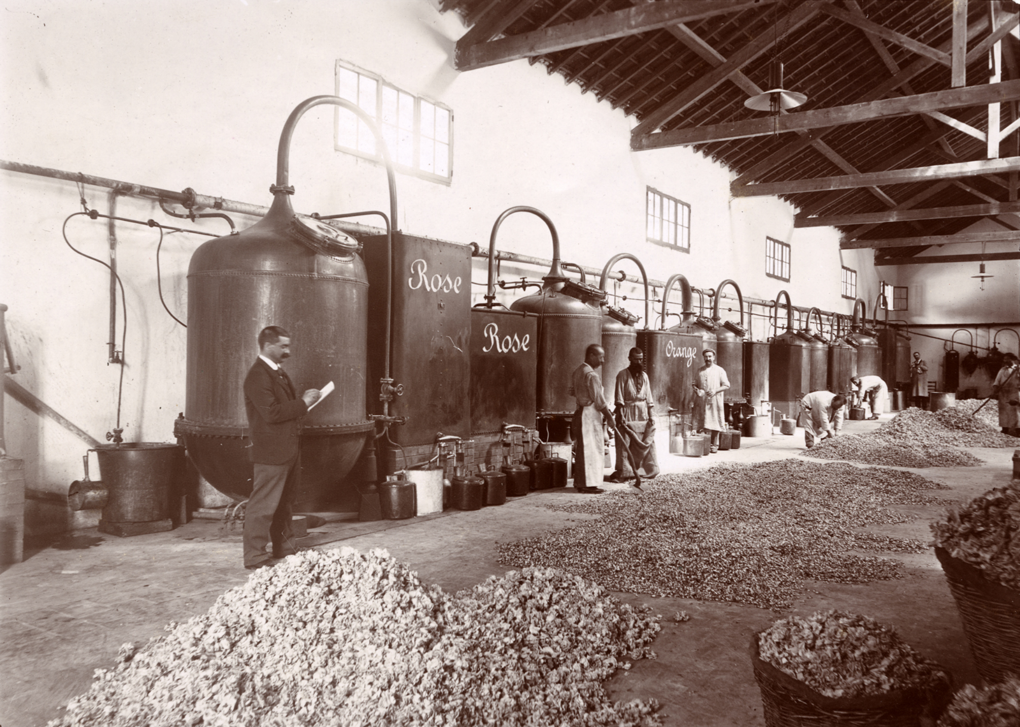
15.9 Alambics de distillation dans une parfumerie grasse, vers 1890. AD06 10Fi 1415
