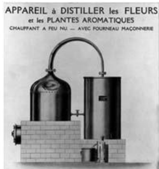
Alambic d'usine à feu nu
