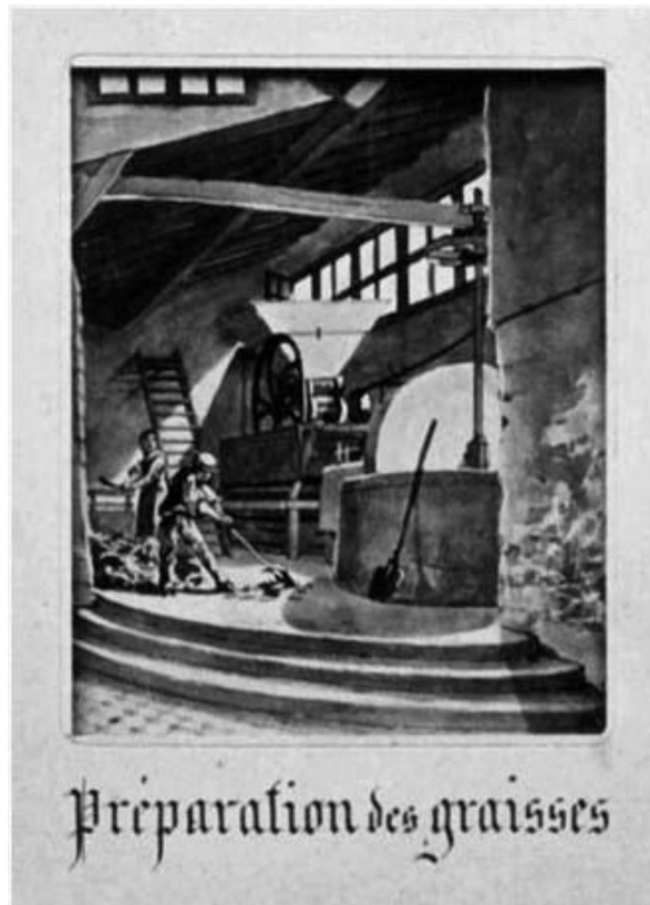
Vue d'un ancien atelier de préparation des graisses qui nécessite une meule identique à celle d'un moulin
