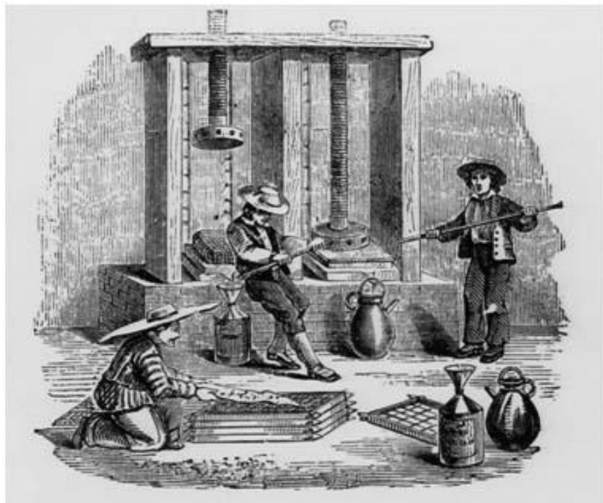
Gravure présentant la technique de l'enfleurage à froid sur huile qui nécessite une presse à bras, également employée pour la fabrication de l'huile d'olive
