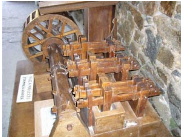
Maquette miniaturisée d'une pile à maillets (3 piles et 9 maillets)
